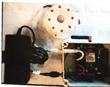
LED آبی روی برد شروع به چشمک زدن میکند و پس از مدتی سرعت چشمک زدن آن کاهش میابد و به سه ثانیه میرسد. در این حالت دستگاه در شبکه رجیستر شده و آماده بکار میباشد.
